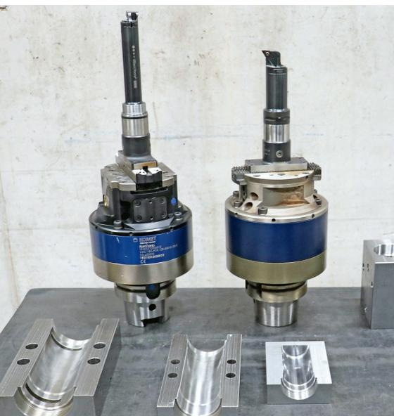
**Evolutionär:** Das System UAS-160 ist bei AHP Merkle in zwei Generationen im Einsatz. Links ist die neue U-Achse UAS160-3 zu sehen; sie läuft noch ruhiger, sodass die Wendeschneidplatten rund 40 min länger gebrauchsfähig sind als bisher © Ceratizit
